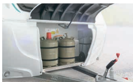
» Ruimte voor 2 gasflessen, de bodem van de disselbak heeft een stabiele en geribbelde aluminium plaat
