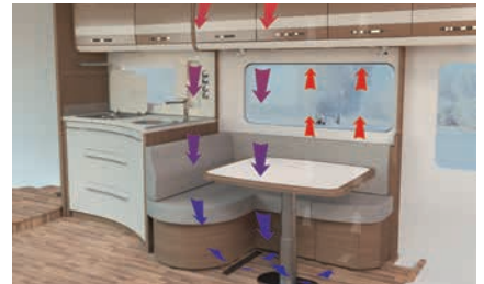
» Airplus systeem voor ventilatie achter de bovenkasten
